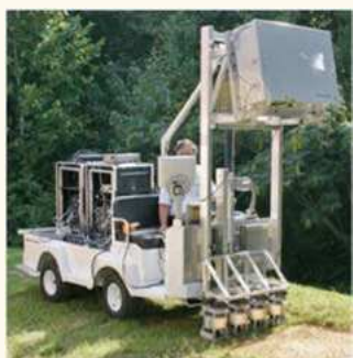
振動計アレイを使用した、テスト地雷レーン上の測定 地中の地雷が、数チャンネルに渡って確認可能
