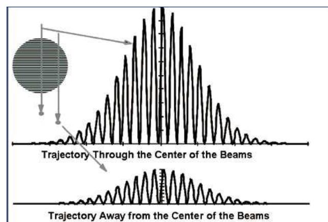
この2本のレーザ光の交差したポイントに、流体中に混入された固体粒子または気体中の液滴が通過すると干渉縞はコントラストを描きます。このコントラストを受光部で検知し、電圧に変換すると、元々レーザ光のもつGaussian特性(中心部強度が大)から山なりになり、ドップラーバースト信号といわれるものが形成されます。
