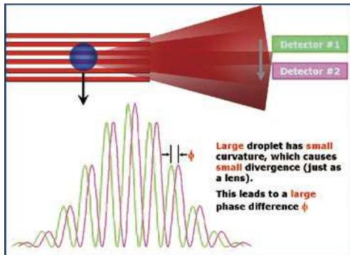
液滴などの球形粒子がこの交差ポイントを通過すると、ここで得られるドップラー周波数  $f$  は、検知器の場所によって位相ずれを起こします。この位相ずれ(位相差)が球形粒子の大きさとリニアな関係になるために、粒子径が求まるのです。
