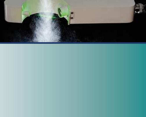
位相ドップラー式粒子分析計：PDIは、非接触で液滴及び固体粒子の流速、粒子径計測が可能なシステムです。レーザーを発光(トランスマッター)側に内蔵しており、1次元はもちろん2次元も光軸調整不要なフルターンキー方式です。各種スプレー、自動車用インジェクター噴霧解析用QC装置等として最適です。
