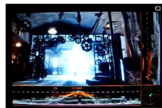
水平波形、垂直波形、ベクトルスコープを表示
