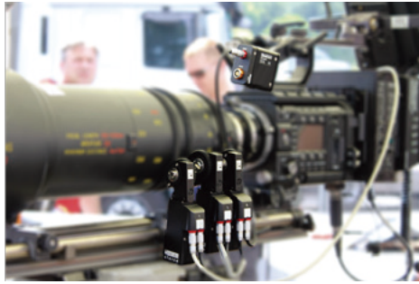
フォーカス、ズーム、アイリスの3モーター を、デジチェーンにて同時仕様可能
