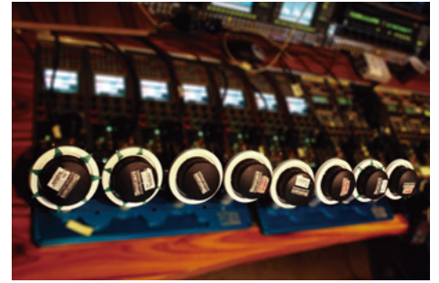
knob soloにて、遠隔アイリスコントロール
